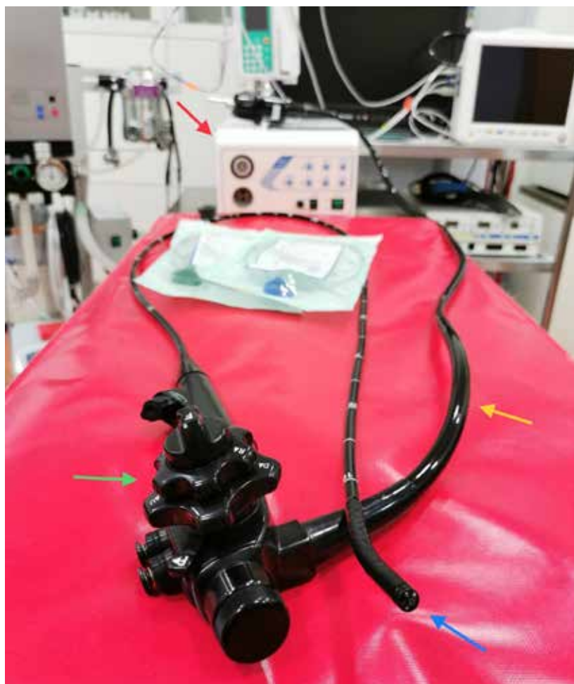
Fleksibilni endoskop - modra puščica kaže na fleksibilno konico, zelena na koleščka za določanje smeri konice, rumena na popkovo, ki endoskop poveže s procesorjem (rdeča p.), ta je povezan z zaslonom
